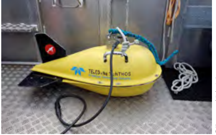
Das für die Akustikmessungen verwendete CHIRP-Sonar der Forschungsgruppe um Ole Grøn (Universität Kopenhagen). The CHIRP sonar used for the acoustic measurements by Ole Grøn's research group (University of Copenhagen).
