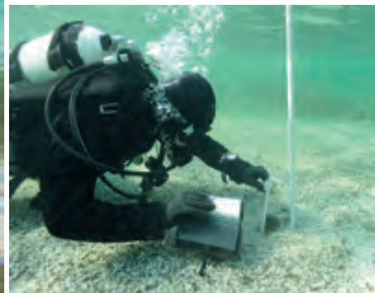
Sipplingen-Osthafen 2022. Forschungs- taucher beim Messen eines Erosionsmarkers inmitten Quaggamuschel-Schalen (Schill). Sipplingen-Osthafen 2022. Research diver measuring an erosion marker amidst quag- ga mussel shells (Schill).
