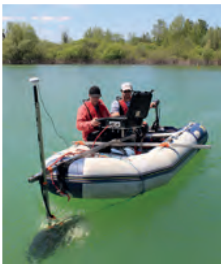
Prospection sismique au moyen d'un pinger Knudsen. Seismic exploration with a Knudsen pinger.
