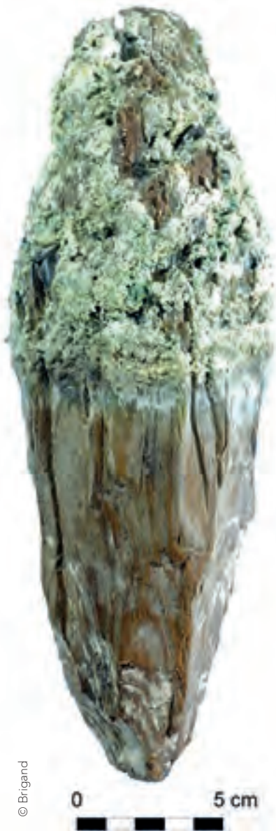
Aspect d'un piquet érodé et déchaussé. Appearance of an eroded and healed post.
